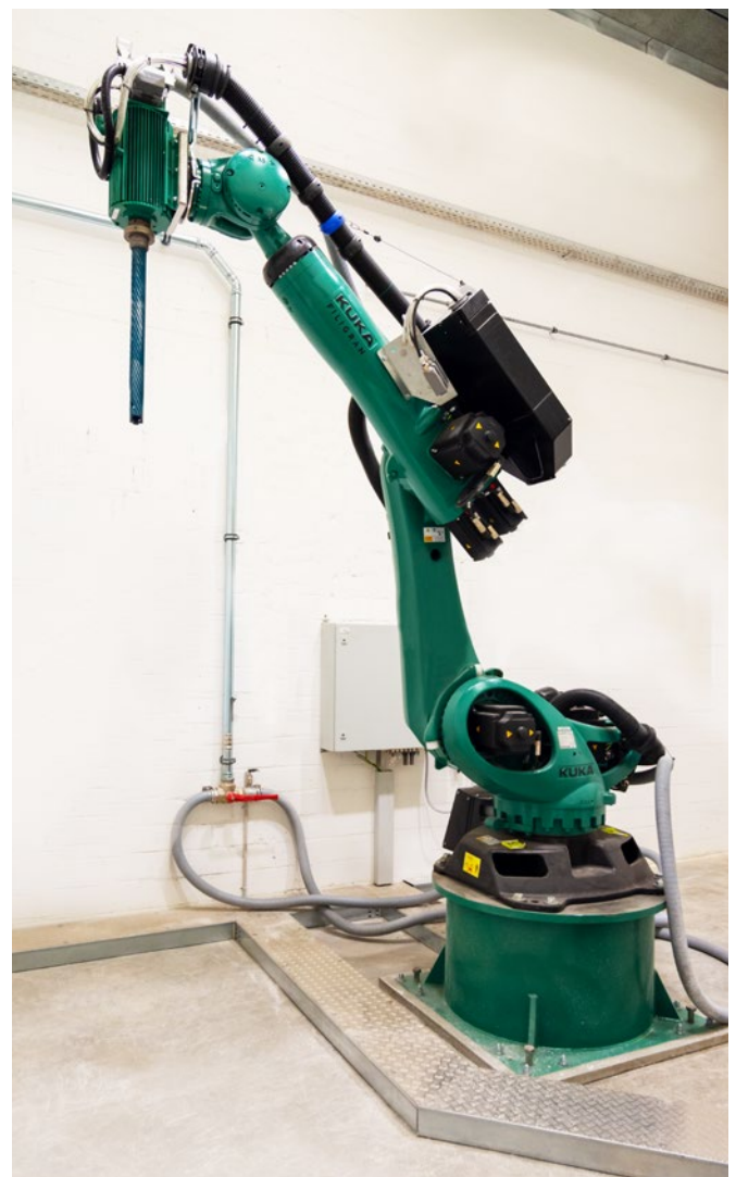
Filigran-Fräsroboter: ein Beispiel für Industrie 4.0 im Bauwesen
