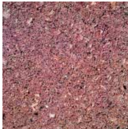
Bild 6: Feingewaschene Betonoberfläche, Rheinsand und Porphyrr 0-16 mm, weißer Zement, 1 % Eisenoxidrot
