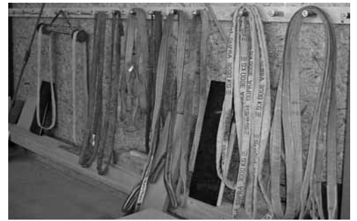
Bild 5: Saubere Lagerung der Anschlagmittel.
