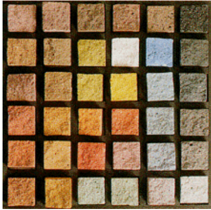
Gebrochene, pigmentierte Mörtelprismen (teilweise mit Grauzement, bzw. Weißzement hergestellt).
