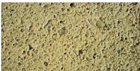
Gestrahlte Betonwerksteinoberfläche Rezeptur: Singhofener Quarz und Weißzement.
