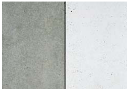
Sichtbeton mit grauem / weißem Portlandzement bei gleichen Gesteinskörnungen.
