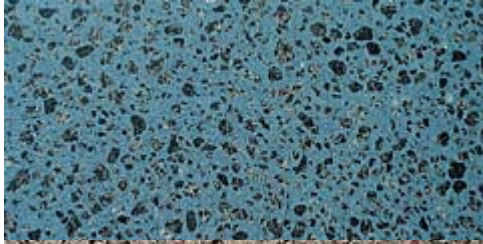
Feingeschliffene Betonwerksteinoberfläche. Rezeptur: Schwarzer Granit, Weißzement und Blaupigment.
