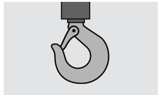
Bild 5: Lasthaken mit Hakensicherung.
