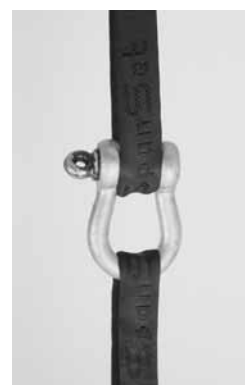
Bild 4: Richtig zusammengefügte Hebebänder.
